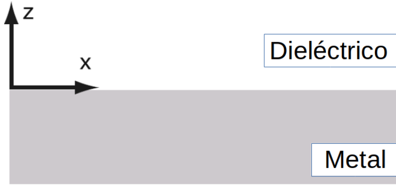
Figura 5: Ilustración de dos medios planos, donde uno es un dieléctrico con una constante dieléctrica real \epsilon_d y el otro es un metal con una constante dieléctrica \epsilon_m .
