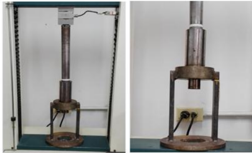
Figura 8. Estructura de reómetro capilar adaptado para extrusión de yeso
