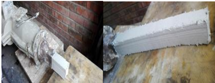
Figura 15. Proceso de extrusión de yeso por tornillo con adición de 0.5% de fibra y R=A/Y= 0,33 .
