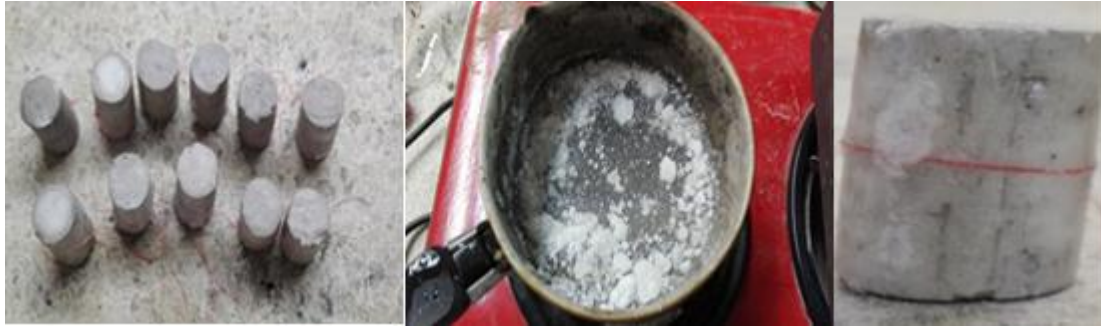
Figura 11. Montaje del método de parafina para hallar densidad aparente.
