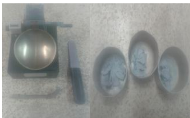
Figura 6. Cazuela de Casa Grande para determinar el LL y recipientes con muestras de montmorillonita para determinar el LP
