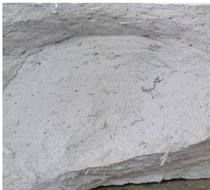
Figura 25. Viga de yeso fracturada con adición de 0.5 % de fibra de fique 33% de R = A/Y .
