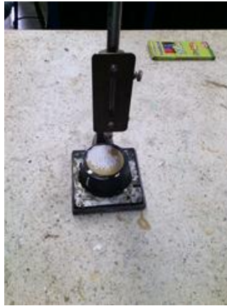
Figura 7. Ensayo de aguja Vicat para determinar tiempo de fraguado utilizando ácido cítrico.
