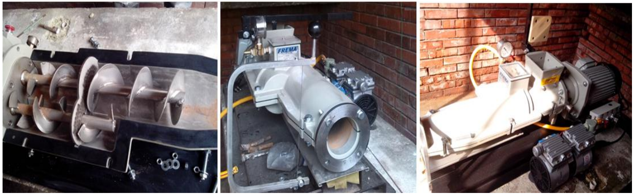
Figura 14. Estructura física de la extrusora y componentes (Castaño et al, 2014)
