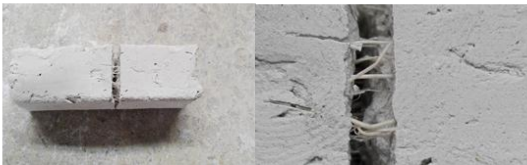
Figura 24. Vigas de yeso parcialmente fracturadas con adición de 0.5% de fibra de fique y 0,33 de R = A/Y .
