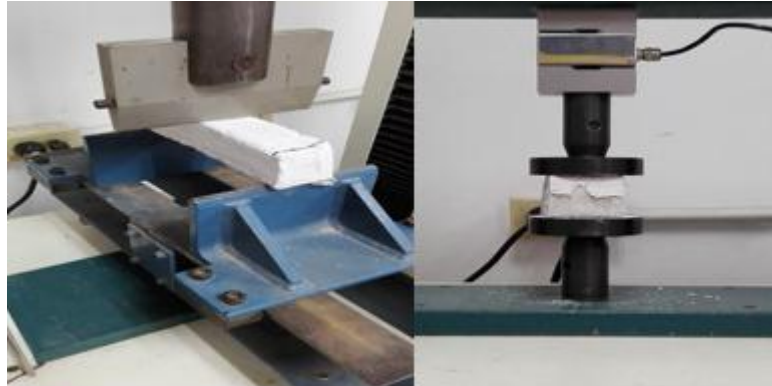
Figura 16. Ensayos de compresión y flexión de las probetas obtenidas por el proceso de extrusión de tornillo.
