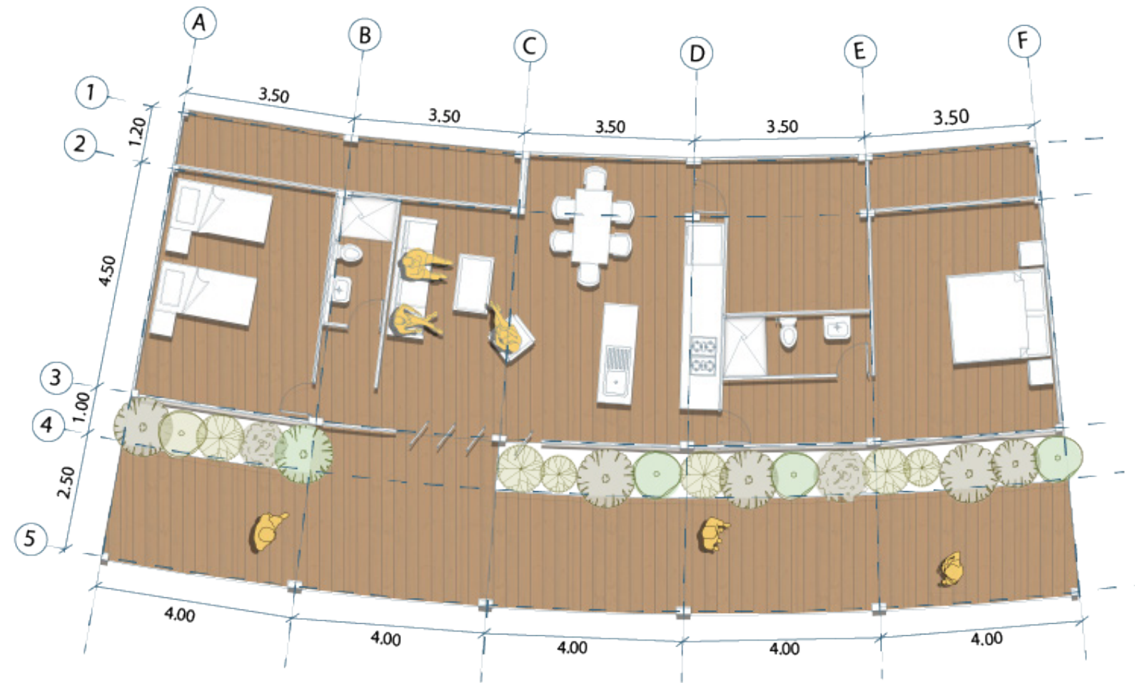
Figura 25. Planta arquitectónica. Elaboración propia.
