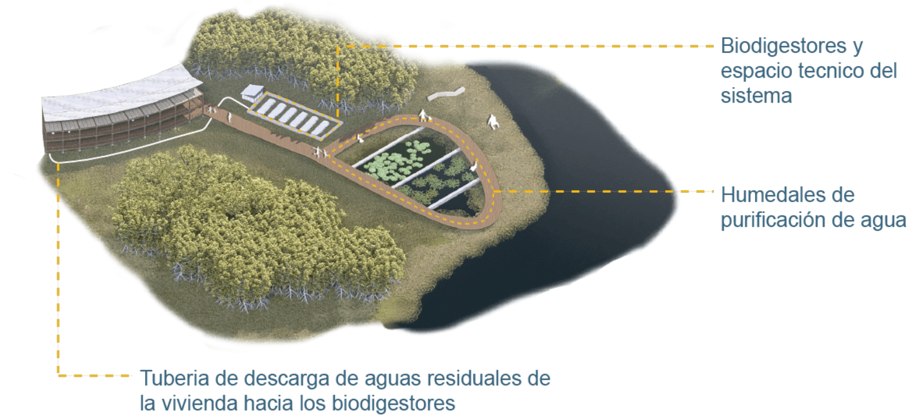
Figura 20. Biodigestor. Elaboración propia.
