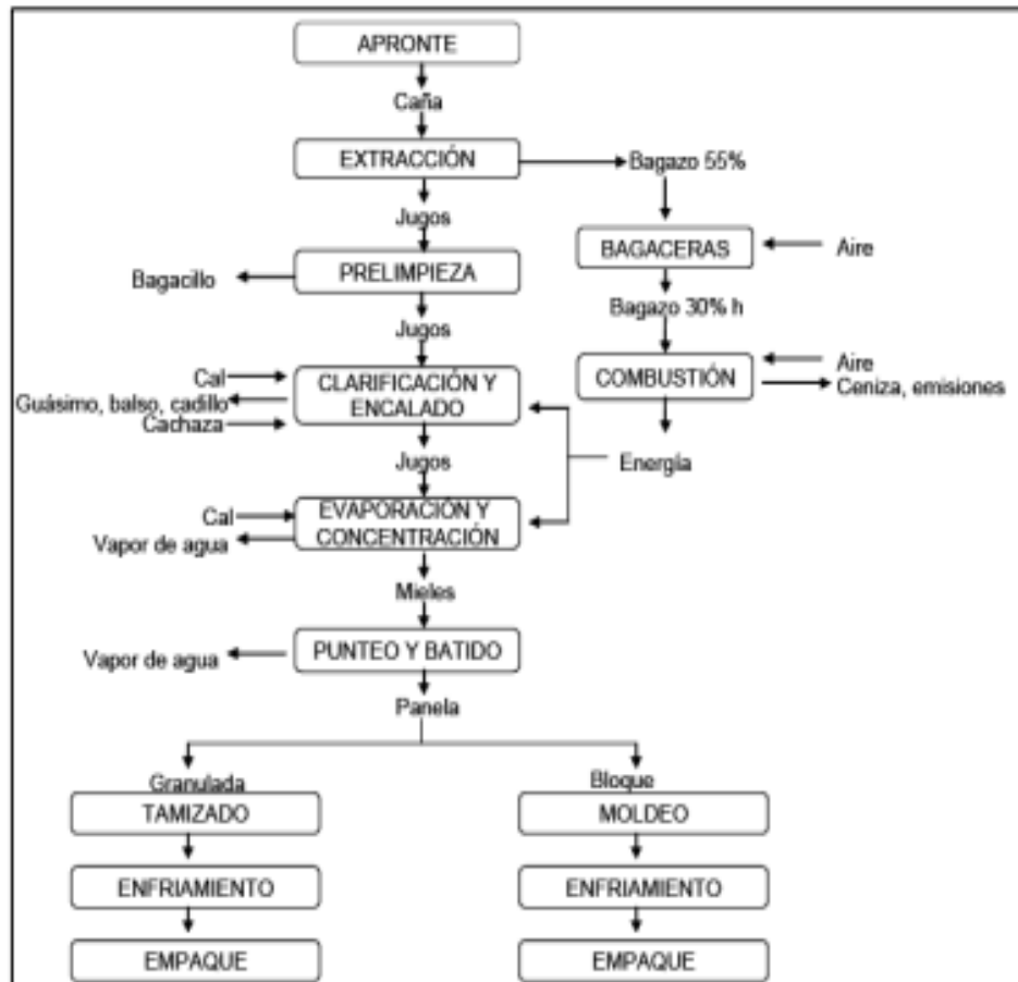
FIGURA 8. DIAGRAMA DE PROCESO PARA LA FABRICACION DE PANELA.
