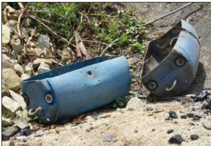
Foto 4-1 Canecas usadas en el proceso de arrastre del carbón en el interior de la mina
