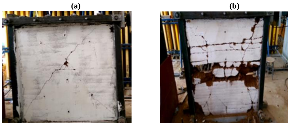
Figura 14. Paredes de tierra apisonada (a) Aglomerante 10% OPC (b) Aglomerante 5% OPC y 5% GBFS. Fuente: (Arslan et al., 2017).
