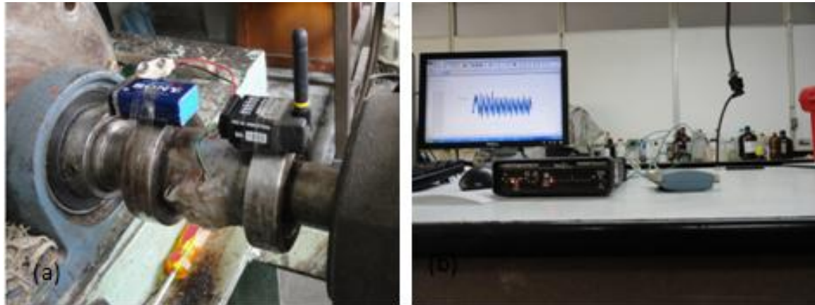
Figura 10. (a) Strain Gage y antena emisora (b) Equipos de recepción y adquisición de datos.
