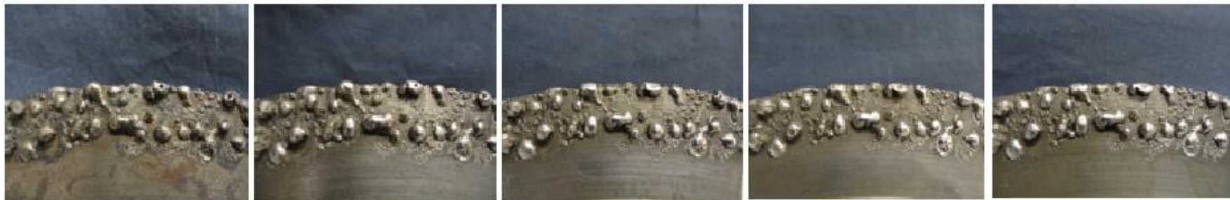
Figura 19. Desgaste progresivo recubrimiento Hipoeutético DFR=0.5
