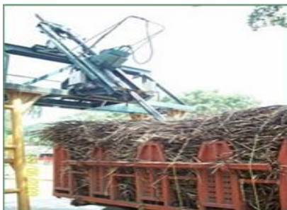
Figura 1. Core Sample, medición de la composición de la caña [11]
