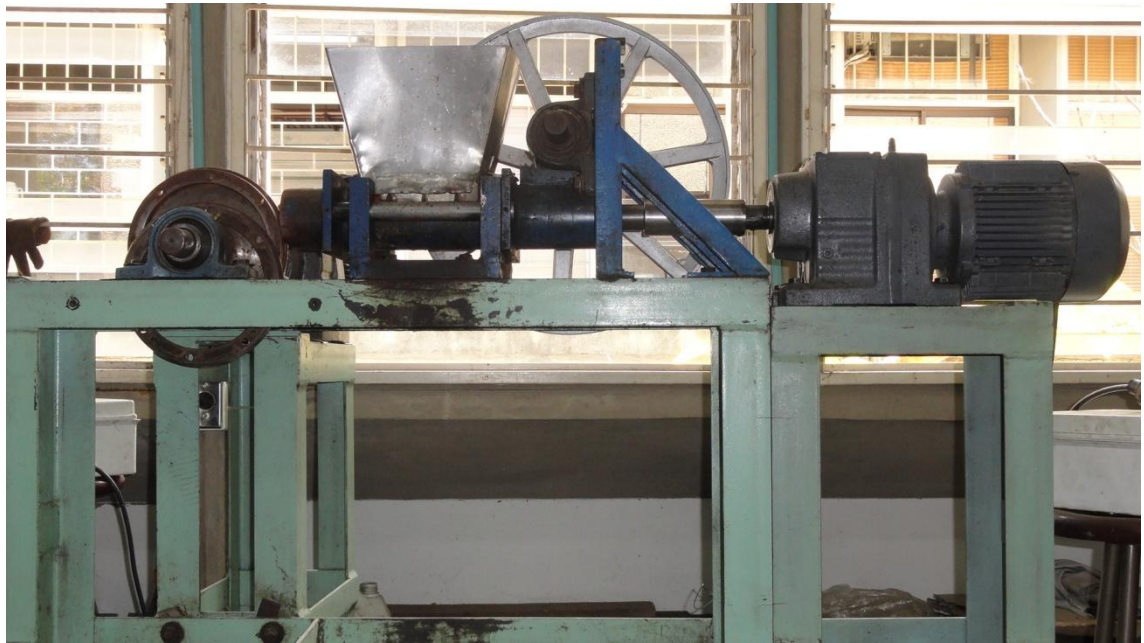
Figura 9. Modificación de la norma ASTM-G65
