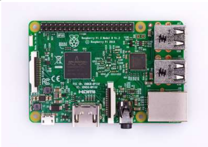
Ilustración 10 Tarjeta Raspberry Pi 3 Model b para realizar el procesamiento de imágenes.
