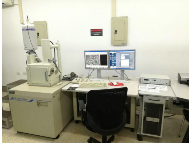
Figura 25. Microscopio Electrónico de Barrido SEM y sonda utilizada para realizar mediciones EDS
