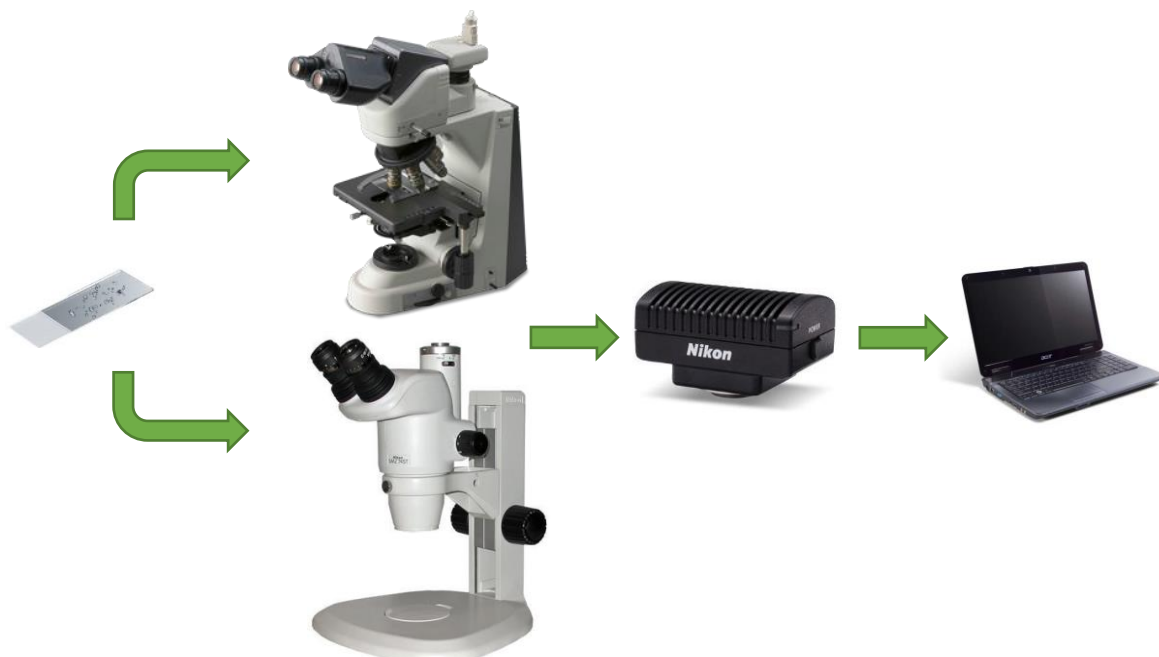
Figura 3.1.1. Microscopio Nikon Eclipse 50i, Estereoscopio SMZ 45T y Cámara DS-Fi3. (Fuente: propia)
