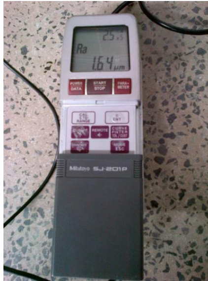
Figura 26. Rugosímetro MITUTOYO SJ-201P.
