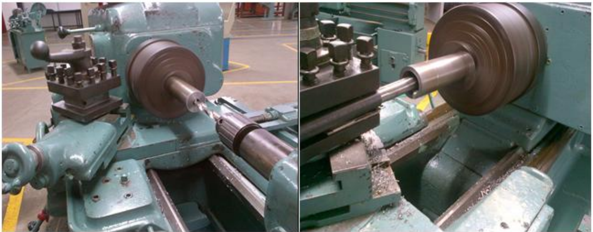
Figura 9. Proceso de elaboración de probetas cilíndricas de acero SAE 1020.
