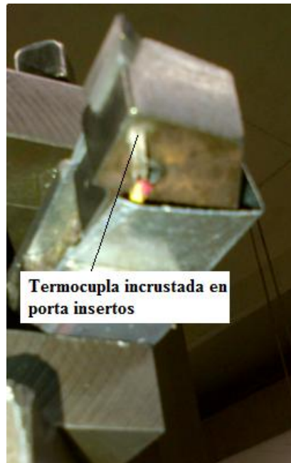
Figura 20. Porta insertos con termocupla incrustada.
