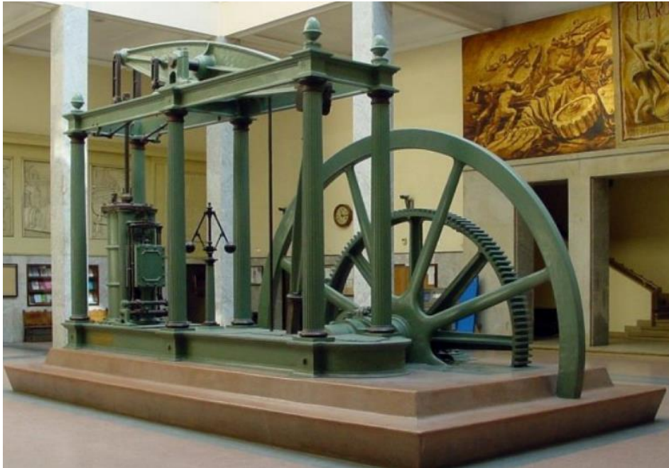
Máquina de vapor de Watt, procedente de la Fábrica Nacional de Moneda y Timbre, expuesta en el vestíbulo de la Escuela Técnica Superior de Ingenieros Industriales de Madrid. Tomado de: https://es.wikipedia.org/wiki/James_Watt#/media/File:Maquina_vapor_Watt_ETSIIIM.jpg
