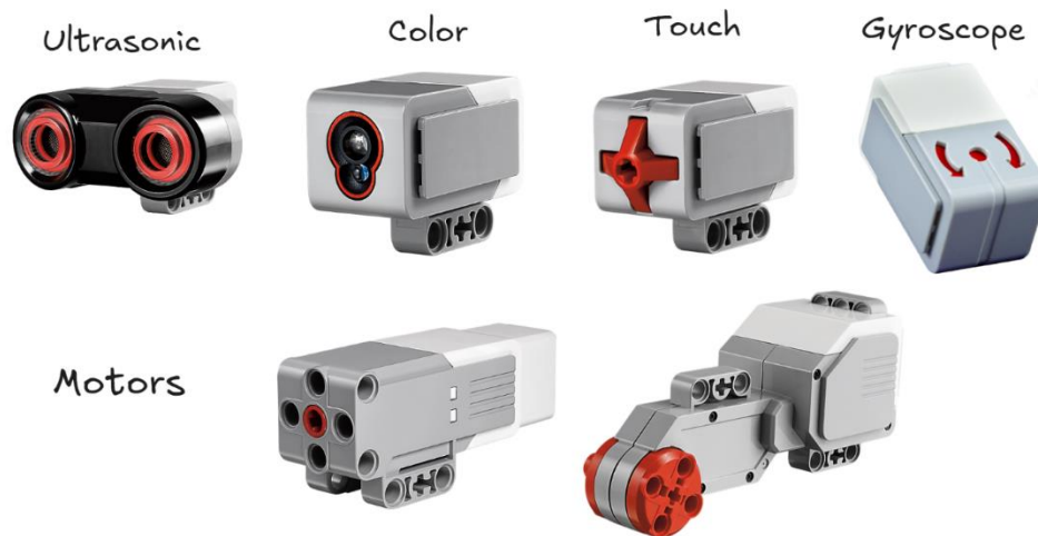
Figura 3.10. Sensores y motores del EV3.
