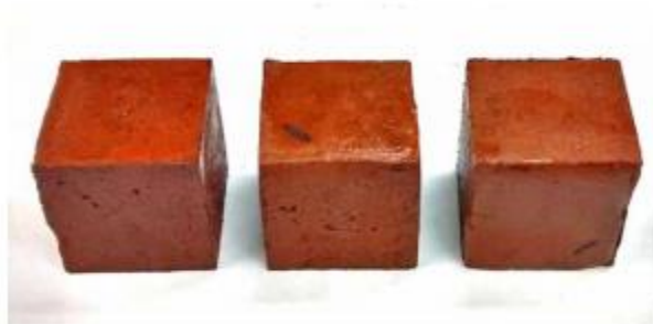
Ilustración 4 Mortero híbrido base (RL) (cubos de 50.8 mm)
