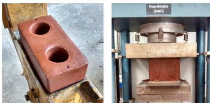
Ilustración 5 (a) Fabricación bloque (RL) (Máquina Cinva Ram); (b) Ensayo de compresión del bloque (RL) Fuente: (Robayo, Mejía, & Mulford, 2016)
