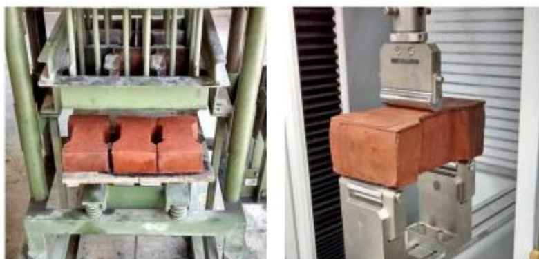
Ilustración 6(a) Fabricación del adoquín (máquina vibro-compactadora); (b) Ensayo de flexo tracción del adoquín (RL). Fuente: (Robayo, Mejía, & Mulford, 2016)
