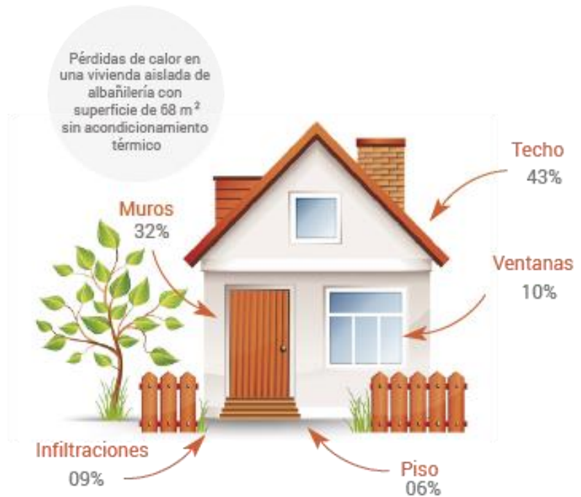
Ilustración 13 Pérdida de calor -- Elaboración propia - Fuente: Manual acondicionamiento térmico CCHC
