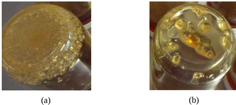
Figura 9. Efecto de la temperatura de almacenamiento sobre el tamaño de los cristales (a) A1-C1-T1, (b) A1-C1-T2
