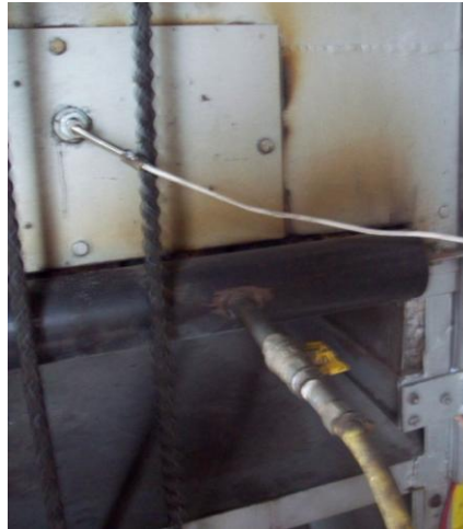
Ilustración 6. Termocupla tipo J en tostadora
