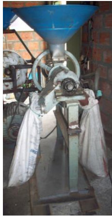
Ilustración 3. Trilladora con dos salidas de cascarilla
