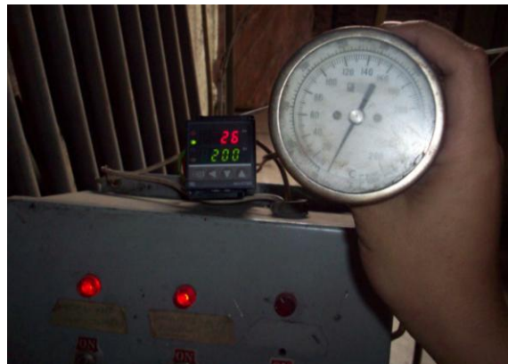
Ilustración 7. Cambio de termómetro por termocupla
