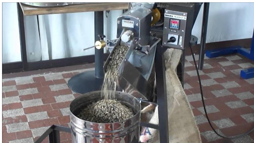
Ilustración 7. Máquina trilladora, Tomada en: Morales, Cauca. Junio 2019
