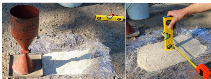
Figura 36 Método del cono y arena.
