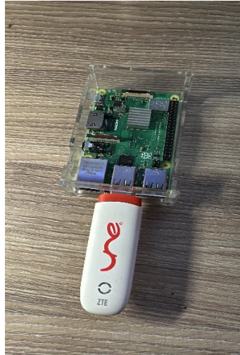
Figura 20. Modem 3G conectado a la Raspberry Pi. Elaboración propia Después de la conexión del hardware se necesita configurarlo en la Raspberry Pi, por lo que se realizaron los siguientes pasos.
