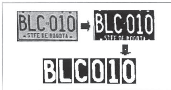
Figura 2: Proceso de segmentación de la placa por detección de color
