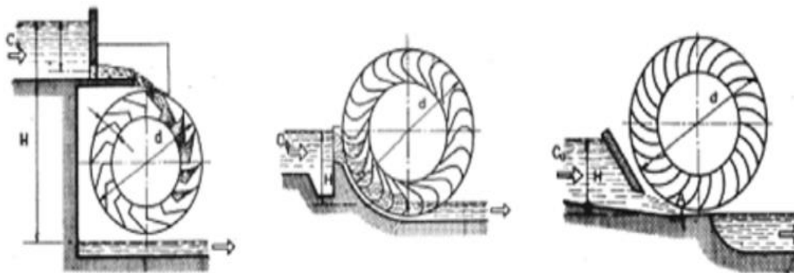
Ilustración 8. Ruedas hidráulicas de empuje superior, empuje lateral y empuje inferior.
