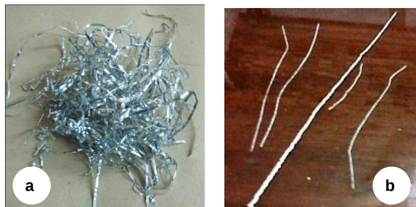
Figura 15. Imágenes de cintas producidas durante las pruebas preliminares a). Aluminio b). Zinc
