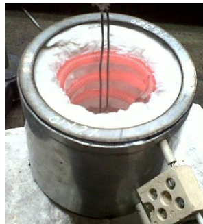
Figura 13. Sistema de fusión construido
