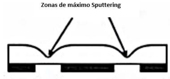
Figura 2.7. Zonas de desgaste del blanco en el sputtering asistido por campo magnético. [12].
