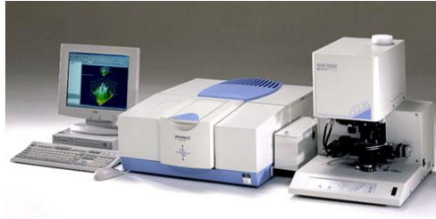
Figura 3.6. Equipo convencional de FTIR.
