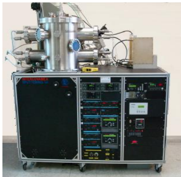
Figura 3.2. Equipo de deposición por PVD ubicado en el CDT ASTIN SENA.
