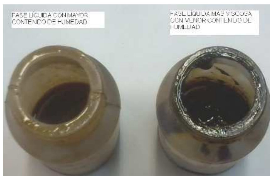
Figura 4. Fase líquida obtenida a partir de pirólisis de RAC en equipo piloto de Cenicaña
