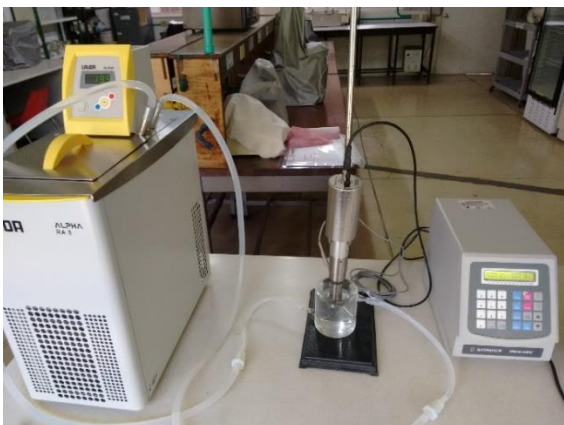
Figura 1. Montaje experimental: a) extracción asistida con ultrasonido, y b) proceso de adsorción continuo.
