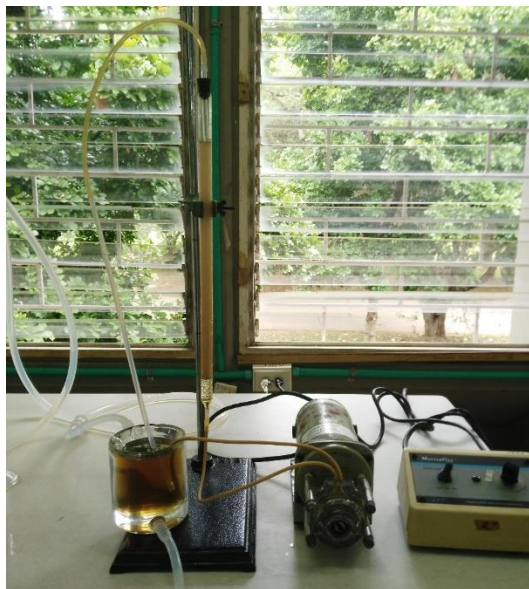
Figura 1. Montaje experimental: a) extracción asistida con ultrasonido, y b) proceso de adsorción continuo.
