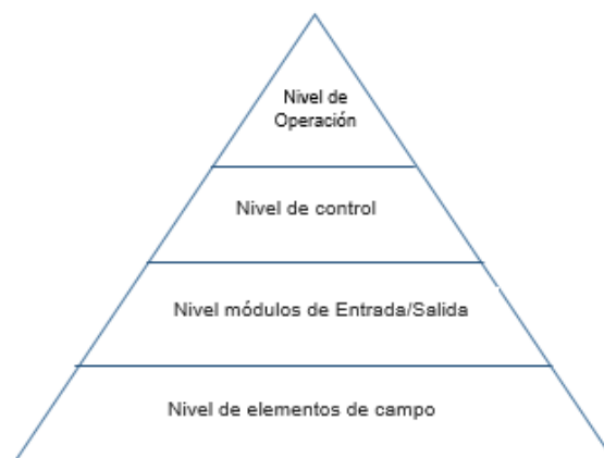
Fig. 2.4. Niveles de un sistema de control distribuido [51].
