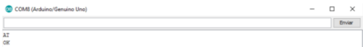
Figura 11 Respuesta del módulo a comando AT.
