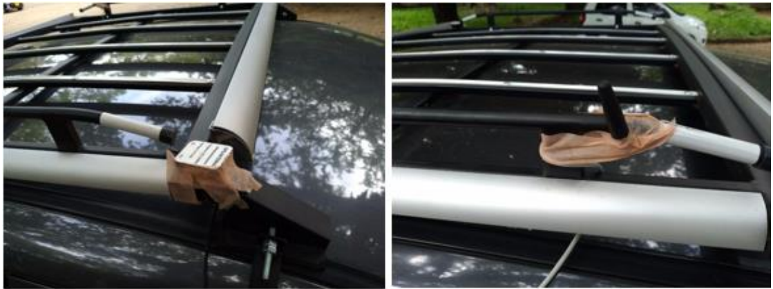
Figura 59 Antena GPS y Antena GSM/ GPRS para envío de datos en el Vehículo. Fuente: Propia
