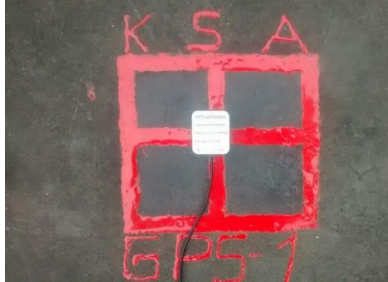
Figura 23 Prueba con GPS del módulo SIM 808 en punto materializado.
