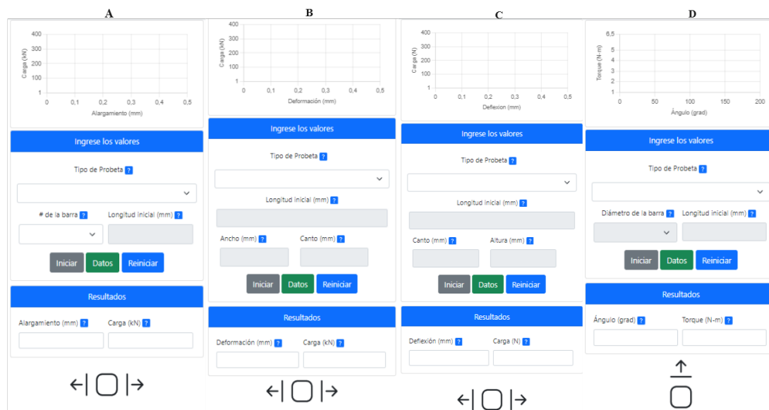
Figura 4.2.: A) Sección del ensayo a tracción, B) Sección del ensayo a compresión, C) Sección del ensayo a flexión y D) Sección del ensayo a torsión
