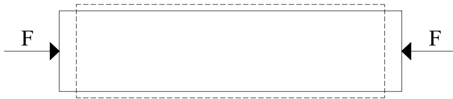
Figura 3.1.: Barra sometida a compresión.
