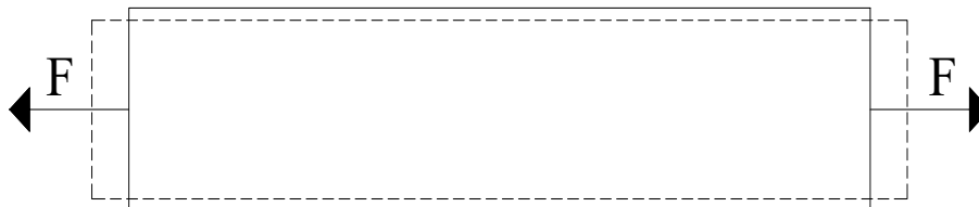
Figura 3.2.: Barra sometida a tracción.
