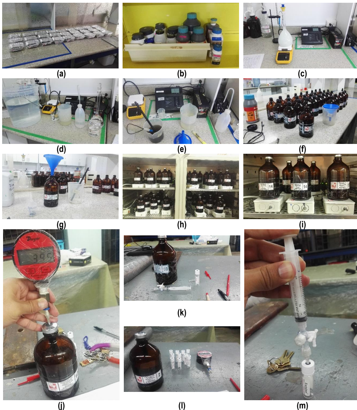
Figura 16. Ensayo de AHE: (a) Inóculo Pretratado; (b) y (c) Preparación de solución de Macro/Micronutrientes; (d) Preparación de sustrato; (e) ajuste de pH Inóculo+Sustrato+ Macro/Micronutrientes; (f) y (g) adición de medio de reacción(Inóculo+Sustrato+ Macro/Micronutrientes) a los reactores, adición de perlas de NaOH y sellado hermético; (h) e (i) fermentación a 35°C; (j) medición de presión; (k) y (l) viales al vacío; (m) toma de muestra de biogás.
