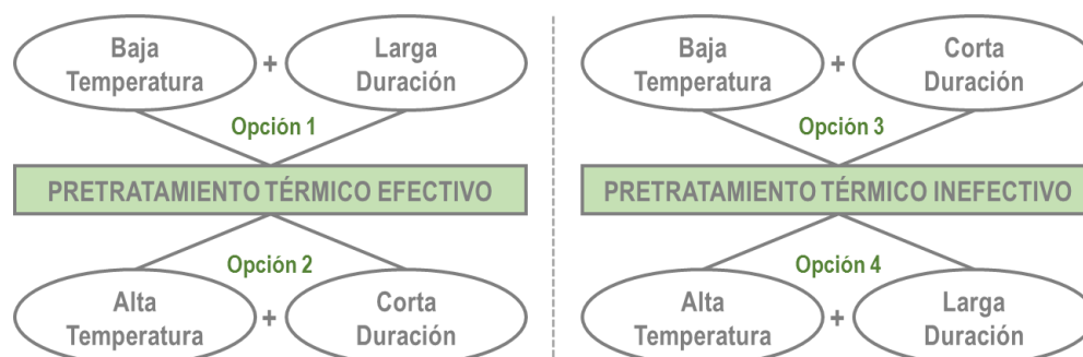
Figura 7. Relaciones entre la magnitud de temperatura y el tiempo de exposición, sobre la efectividad del pretratamiento térmico de un inóculo
