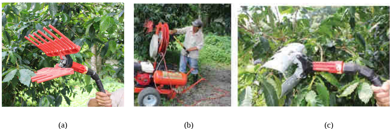
Figura 25: Batidores usados para la recolección de café. (a) Batidor MAIBO, (b) fuente de potencia y (c) batidor diseñado en Cenicafé. Fuente (a) Álvarez, & otros, 2013b, p. 6922. Fuente (b): Álvarez, & otros, 2013b, p. 6925.
