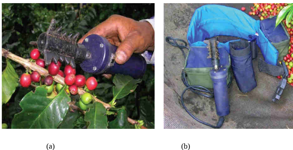
Figura 23: Vista general del impactador del equipo Alfa (a) y del prototipo completo incluyendo la fuente de potencia (b). Fuente: Moreno, Oliveros, y Álvarez, 2015, p. 7473.
