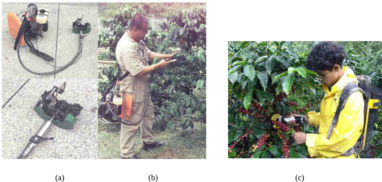
Figura 24: Vista general del desgranador de café DESCAFÉ I (a), su utilización (b) y operación del DESCAFÉ IV (c). Fuente Izquierda: Ramírez, & Oliveros, 2003, p. 4. Fuente derecha: Ramírez, Álvarez, Oliveros, y Sanz, s.f.a, p. 4.
