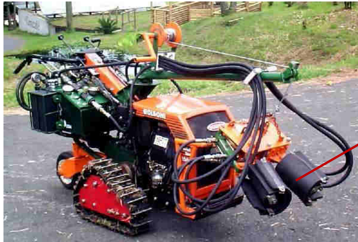
Figura 14: Vista general de un vibrador inercial de tronco para la cosecha de café. Fuente: García & Oliveros, 2003. p. 4.
