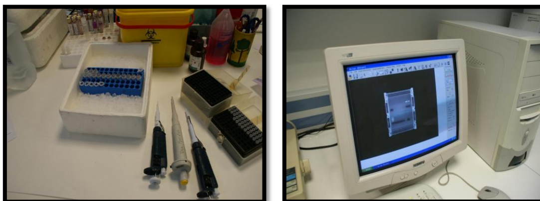
Figura 10. Manejo de las muestras para obtener RNA de buena calidad y estudio de su integridad con gel de agarosa
