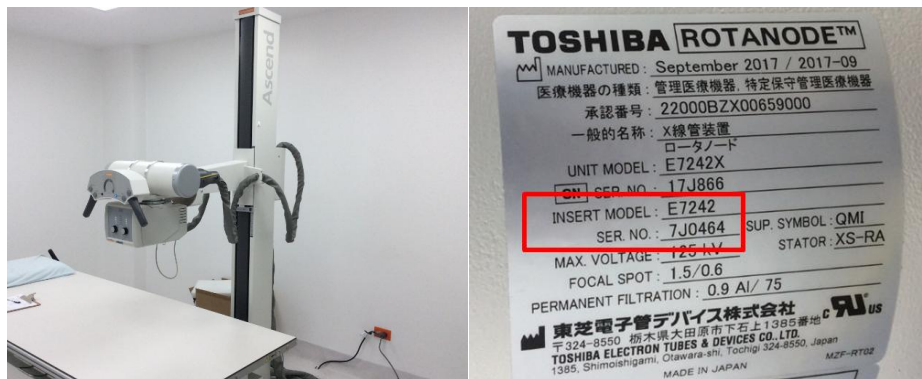
Figura 5.1 Equipo de rayos X convencional Clínica Colsanitas con su placa de seriales.
