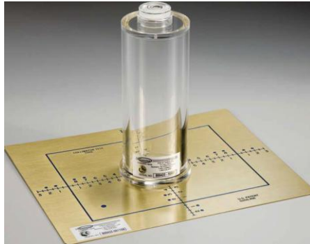
Figura 4.4 Herramienta para verificar la alineación y colimación del haz
