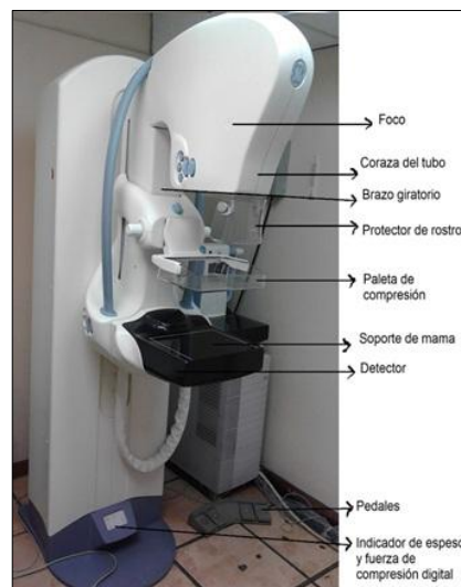
Figura 2.4 Equipo de mamografía con sus partes principales
