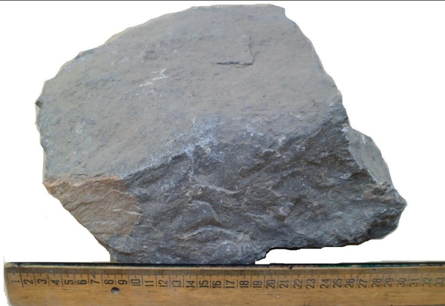
Caliza AZ empleada para estructurar la bóveda del horno
