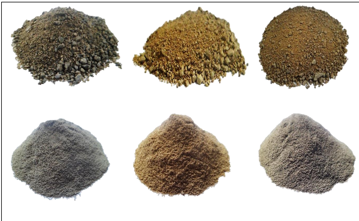
Figura 15. Caliza de diferentes calidades después de un proceso de conminución.
