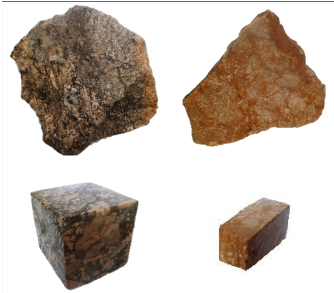
Figura 14. Adecuación de especímenes para caracterización mecánica. izq) Probeta para R. Compresión, der) Probeta para R. flexión.
