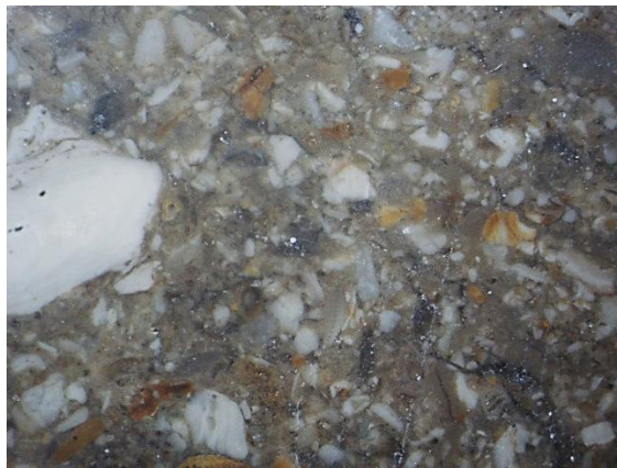
Figura 32. Sedimentos clásticos cementados en matriz calcítica a 5X (Roca MB).
