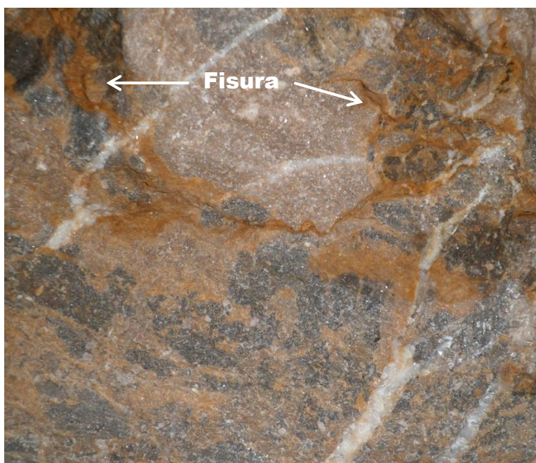
Figura 18. Micrografía (5X) de sección pulida de la roca AR revelando fisuras en su estructura.
