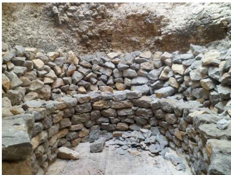
Figura 36. Tamaño y disposición común de la caliza empleado para producción de cal en un horno tipo colmena
