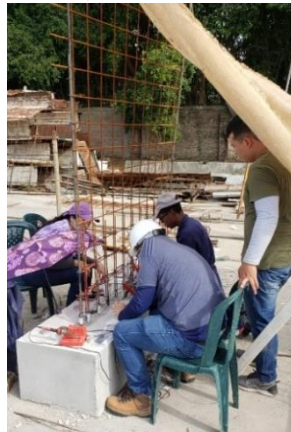
Instalación de galgas internas en el refuerzo, encofrado y fundición de los muros
