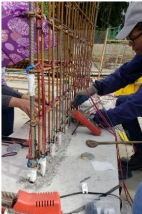
Instalación de galgas internas en el refuerzo, encofrado y fundición de los muros
