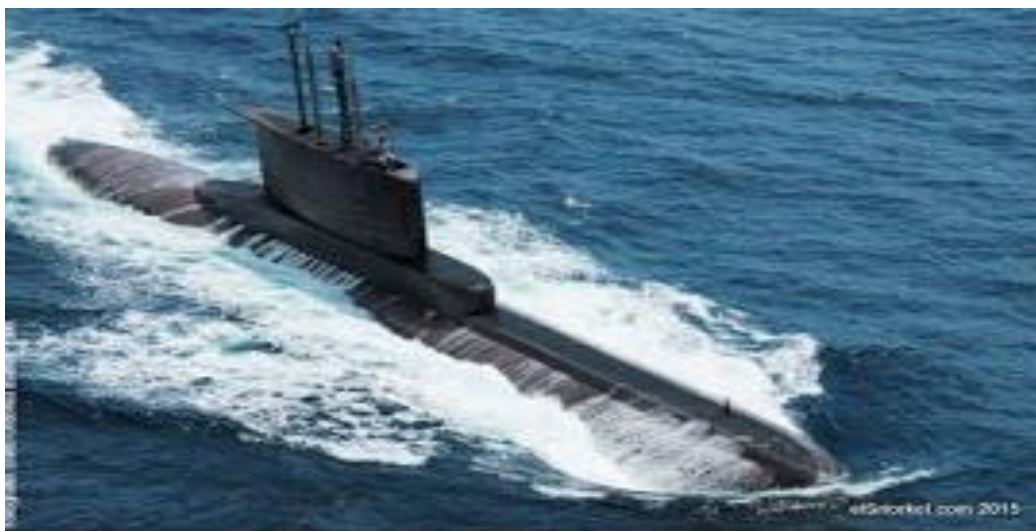
Figura 36: Fuerza Submarina de Colombia 40 años. Armada República de Colombia, abril 2013. [Fotografía]. Submarino alemán tipo HDW 1.200. Submarino no nuclear más exitoso a nivel mundial 63 unidades bajo contrato. Desplazamiento: 1.180/1.285 m 3 , eslora: 55,87 metros, manga: 6,20 metros, puntual: 11,386 metros, velocidad: 12/22 nudos, autonomía: más de 30 día, tubos: L/T 8, dotación: 7 oficiales, 27 suboficiales, diseño: profesor Ulrich Gabler IKL de Lübec, Alemania. Archivo fotográfico de la Armada Nacional. Pág. 68
