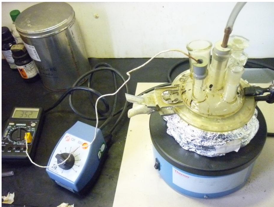
Figura 3. Montaje del reactor de vidrio
