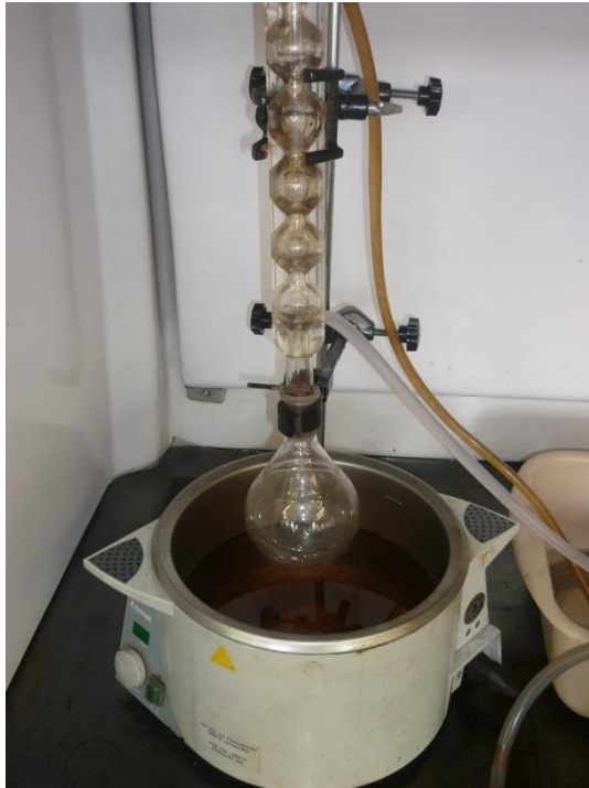
Figura B1: Sistema de extracción
