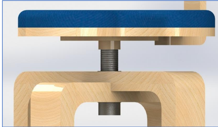
Figura 27: Mecanismo de extensión de estatura. Fuente: Autora.
