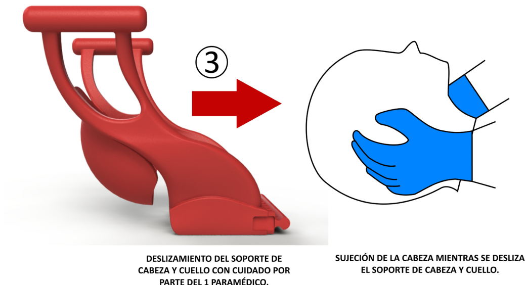
[Gráfica_17] SECUENCIA DE USO SOPORTE DE CABEZA Y CUELLO. PASO No.3. Fuente: Autor.
