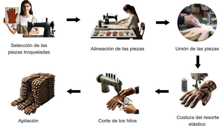
Figura 4. Proceso de armado
