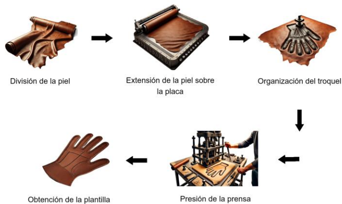
Figura 3. Proceso de troquelado
