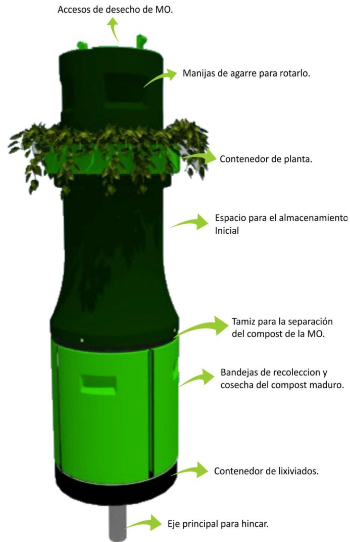
Figura 11 Objeto de Almacenamiento y Tratamiento Exterior
