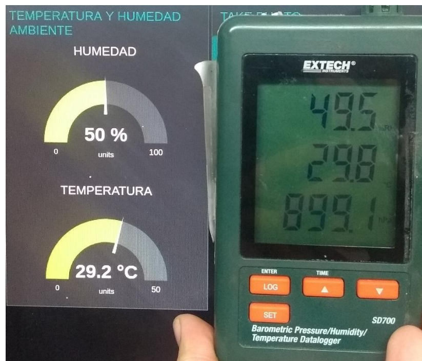
Figura 44. Comparación de la medición de temperatura y humedad ambiente entre DHT11 (izquierda) y sensor SD700 EXTECH calibrado.
