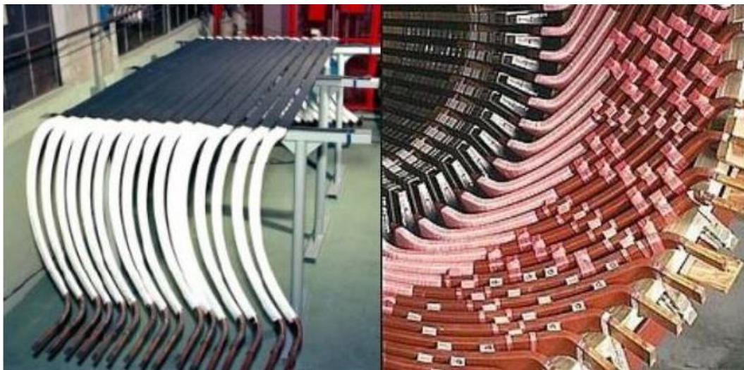
Figura 32. Tipos de bobinas que forman el devanado del estator (Barras tipo Roebel).
