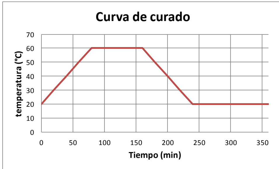
FIGURA 43 CURVA DE CURADO TERMICO APLICADO A LAS PIEZAS DEL TRASPORTADOR.
