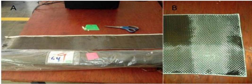
FIGURA 21 A) TELA DE FIBRA DE CARBONO DELIMITADA CON CINTA Y B) RECORTADA A LA MEDIDA.
