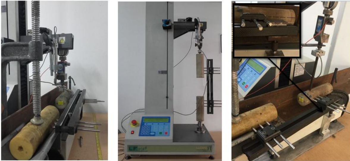
FIGURA 51 CONFIGURACIONES EXPERIMENTALES PARA LAS PRUEBAS DE FLEXION Y CARGA AXIAL
