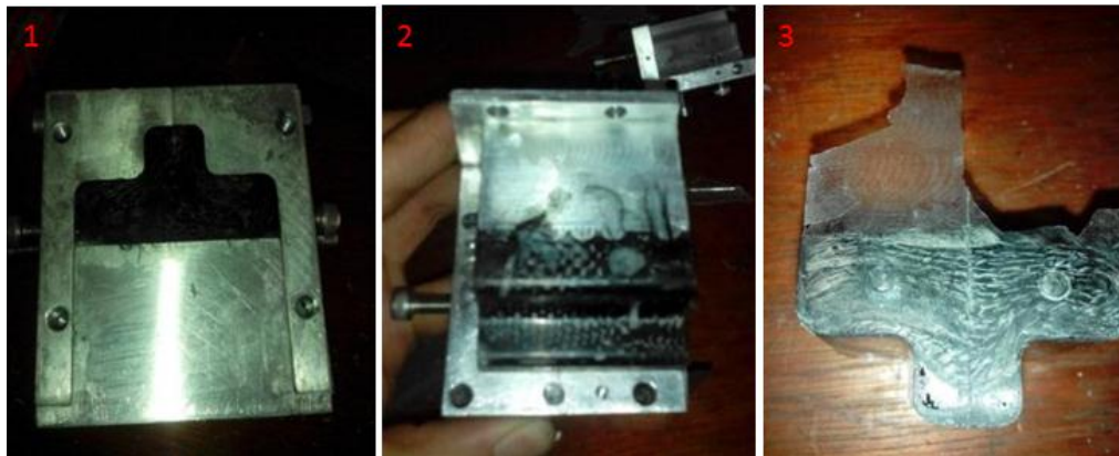
FIGURA 18 SECUENCIA DE PASOS PARA DESMOLDAR.
