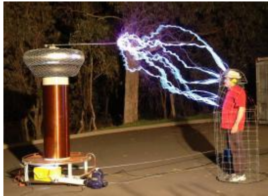
Figura 17 Jaula de Faraday en maya conductora, protección a una persona.
