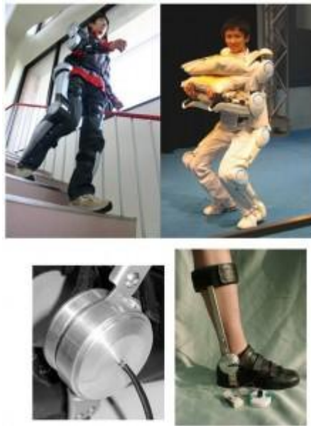
Figura 8 Exoesqueletos creado por la compañía Japonesa Cyberdyne Inc cuenta con rotulas de FMR. [12]
