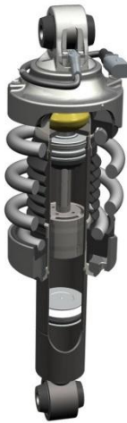
Figura 9 Suspensión magnética magneride de la marca BWI. [13]
