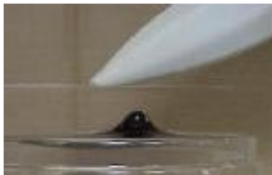
Figura 34 Respuesta de un ferrofluido con 21% de magnetita en aceite comestible al acercarle un magneto [27]
