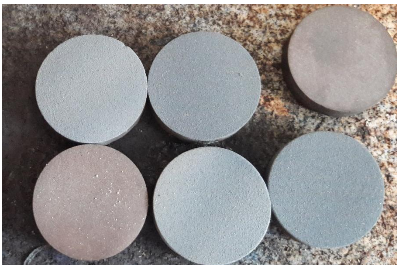
Figura 46. Fotografía de la superficie de los recubrimientos después del ensayo de Ciclado Térmico
