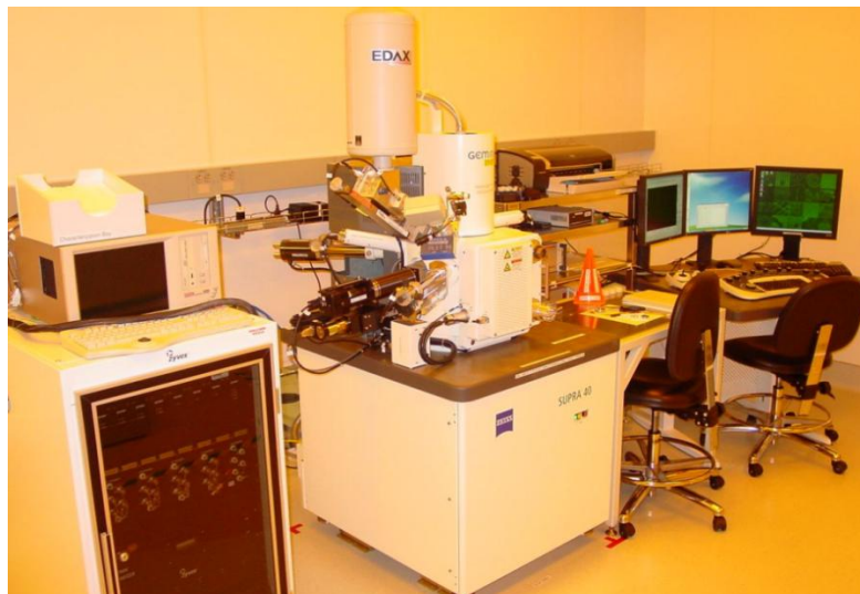
Figura 29. Equipo de Microscopia Electrónica de Barrido (SEM) y Espectroscopia de Energía Dispersiva (EDS)
