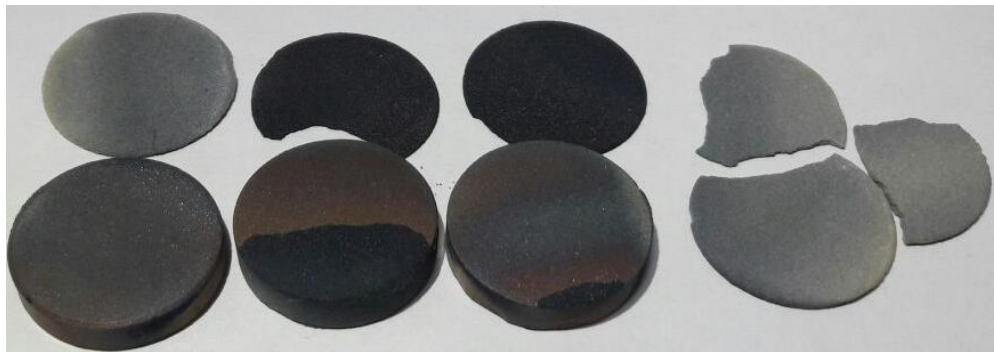
Figura 33. Fenómenos de delaminación presentados en los recubrimientos
