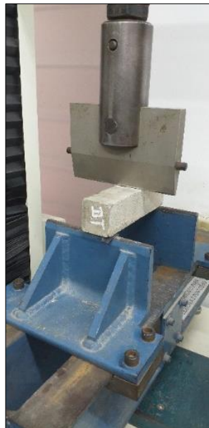
Figura 12 Ensayo de resistencia a flexión para morteros Fuente: propia.
