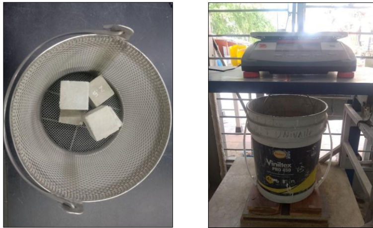
Figura 13 Montaje para ensayo de densidad, porosidad y absorción. Fuente: propia.
