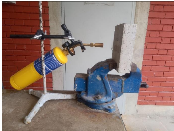
Figura 22. Montaje de ensayo de llama directa. Fuente: propia.
