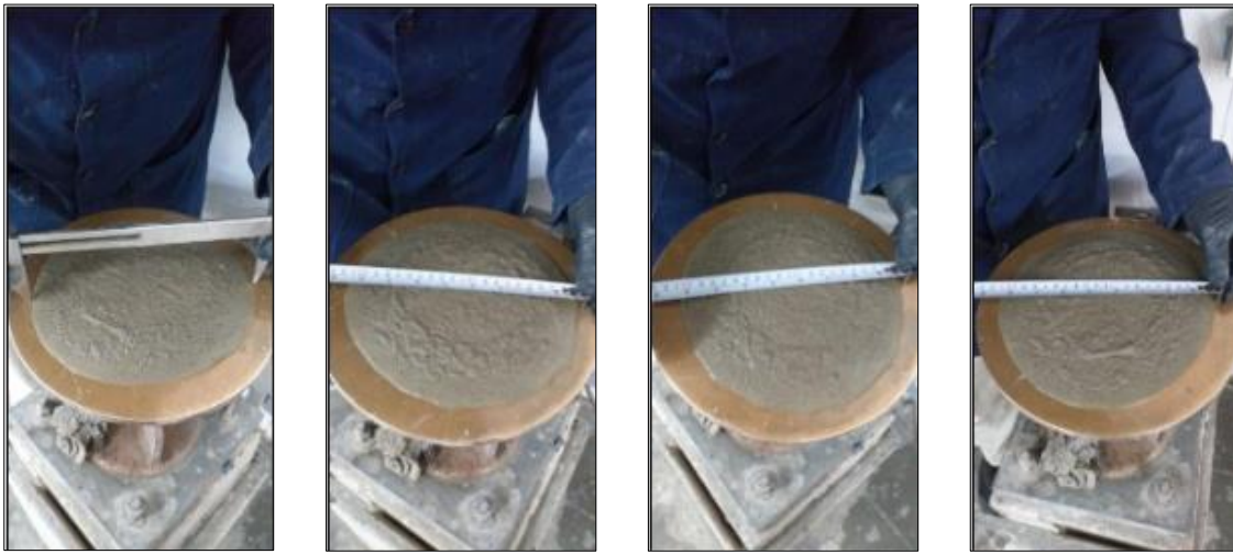
Figura 30. Ensayo de Fluidez para morteros. Fuente: propia.
