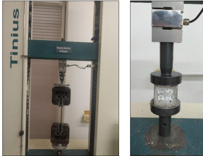
Figura 11. Ensayo compresión para morteros Fuente: propia.
