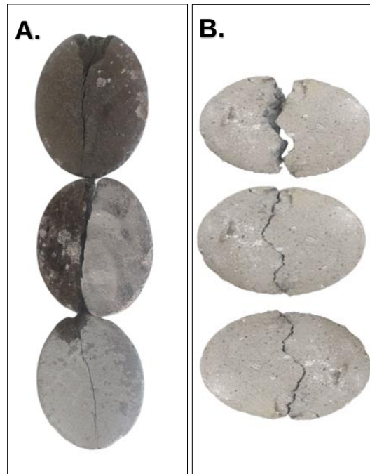
Figura 39 Evidencia ensayo tracción indirecta A. Referencia B. AR Fuente: propia
