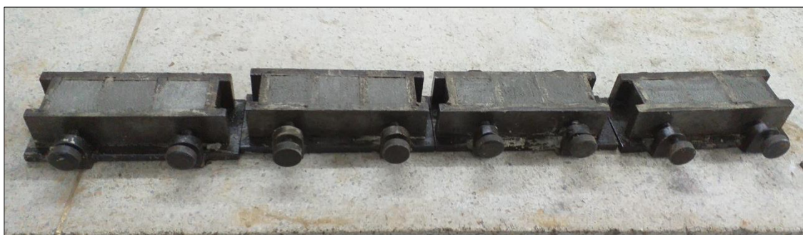
Figura 10. Fabricación de cubos de morteros. Fuente: propia.
