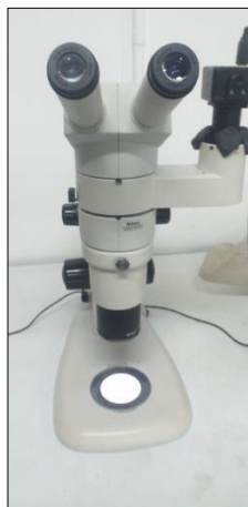
Figura 8. Estereoscopio usado para analizar PEBD-Al. Fuente: propia.
