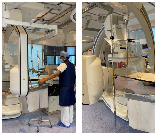
Figura 3.8: Medición de tasa de dosis con laminas de PMMA
