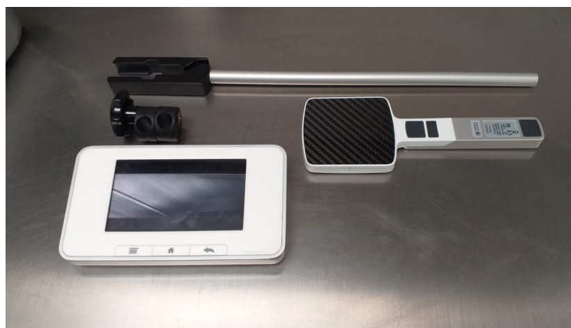
Figura 3.2: Equipo RaySafe X2 con sensor Survey
