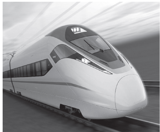
(b) El tren japonés Shinkansen, cuya nariz se inspiró en el martín pescador, para mejorar su eficiencia aerodinámica y mitigar el efecto de las explosiones sónicas.
