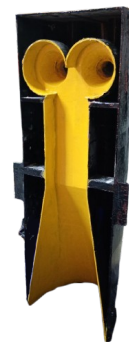
(b) Mitad inferior del hidrogenerador.
