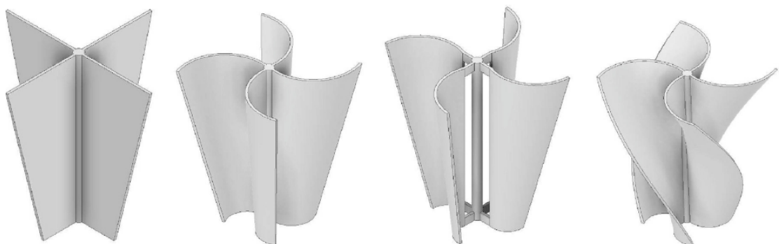
Figura 2.8: Rodetes típicos utilizados en hidrogeneradores de vórtice vertical. De izquierda a derecha, por la forma de sus palas: planas, curvas, de flujo cruzado y con ángulo de torsión. Fuente: [4]
