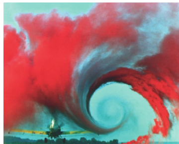
Figura 2.1: Fotografía del vórtice que se desprende de una de las alas de un avión de fumigación agrícola. Fuente: [6]
