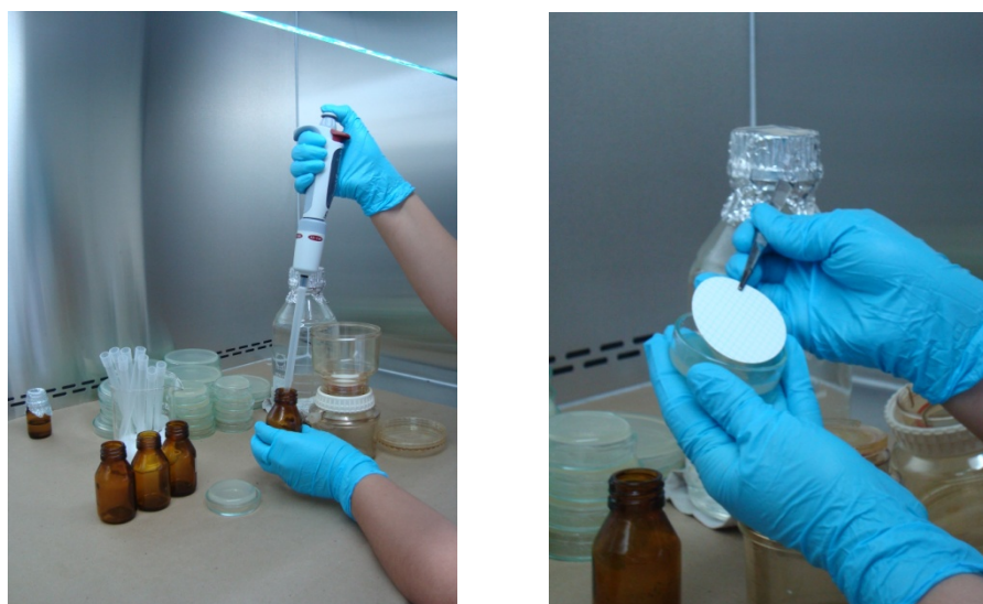
Figura 7. Siembra de bacterias por medio del método de filtración por membrana.
