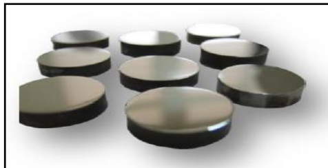
Figura 42. Probetas de acero con dimensiones de 12,7 mm diámetro y espesor de 5 mm
