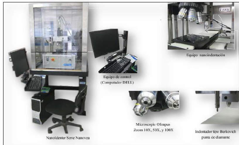
Figura 52. Equipo de Nanoindentación y rayado SCRATCH TESTER Serie NANOVEA MICROPHOTONICS Modelo MTR3/50.
