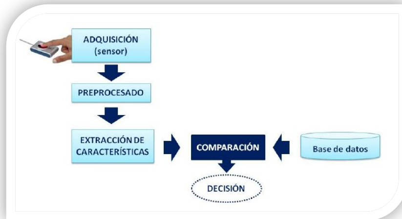
Ilustración 9: Funcionamiento de un Lector Biométrico
